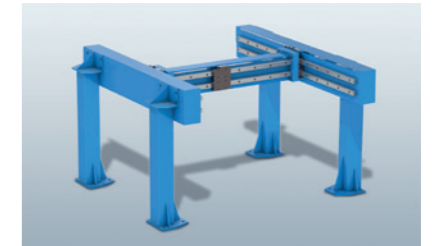
Synchronisation der Vorschubmotoren bei Gantry-Antrieben mit jeweils einem eigenen Messsystem
