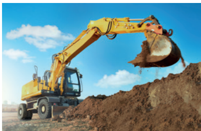
Automatisierte Erdbewegungen durch intelligente Positionserfassung des Auslegers, des Stiels und der Schaufel
