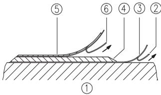
Abb. 1: Montage Magnetband
