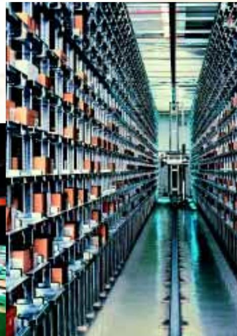
Bei Applikationen in Hochregallagern müssen weite Verfahrswege erfasst werden. Durch die Distanzmessung mit dem LAS-System werden lange und problematische Kabelführungen elegant vermieden.
