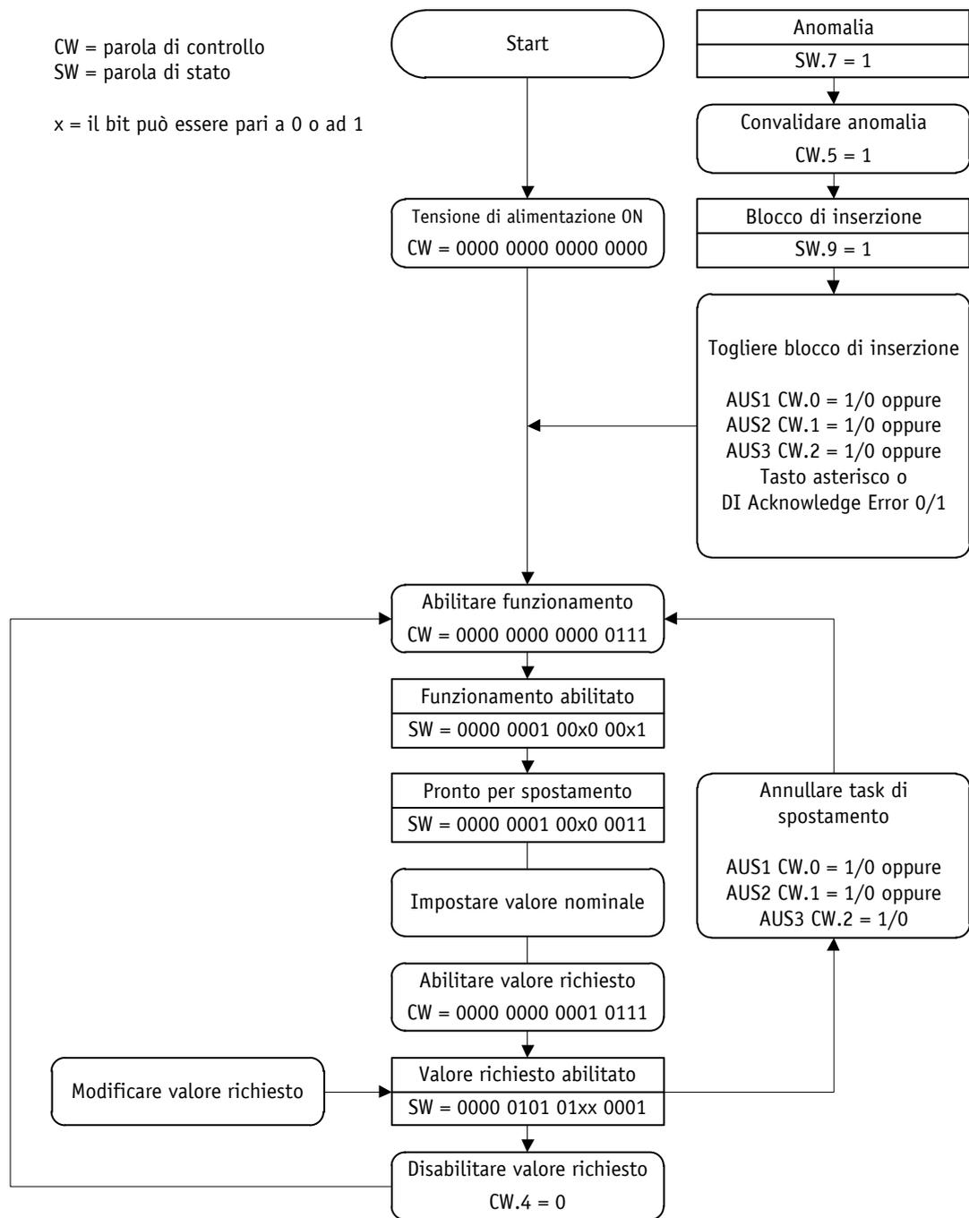
Fig. 15: diagramma di flusso modo Velocità
