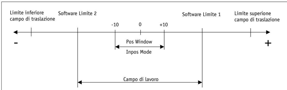
Fig. 5: modo posizionamento
