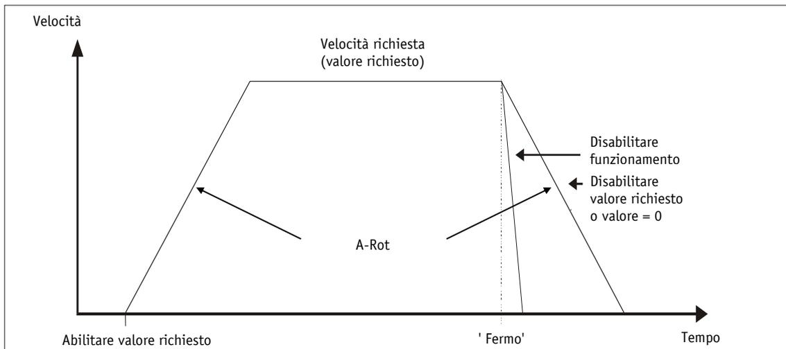
Fig. 14: rampa modo Velocità
