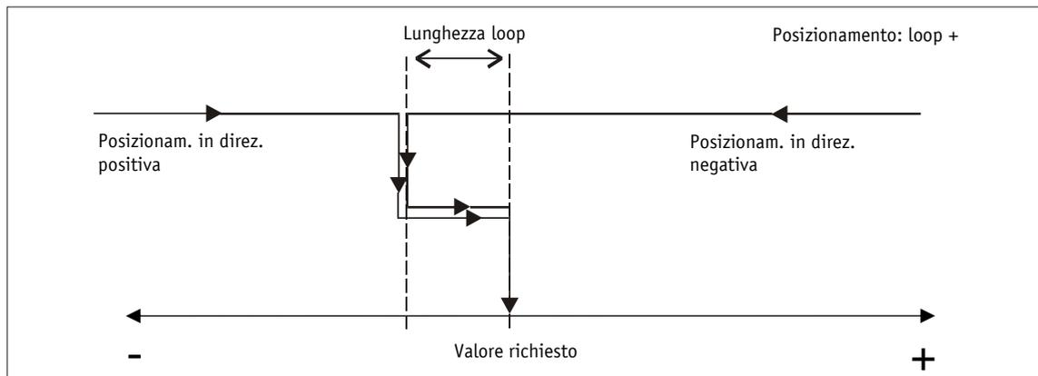
Fig. 8: posizionamento loop+
