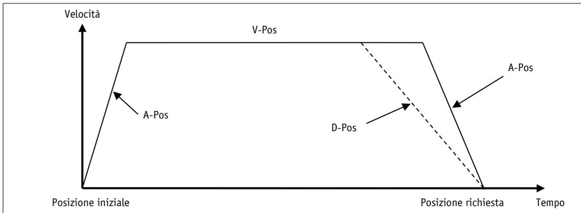
Fig. 4: rampa con modo posizionamento diretta
