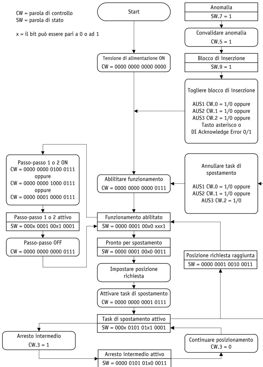
Fig. 9: diagramma di flusso modo posizionamento
