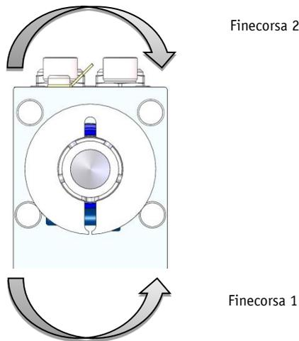
Fig. 7: disposizione dei finecorsa
