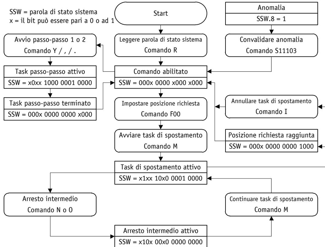
Fig. 18: diagramma di flusso modo Posizionamento protocollo di servizio
