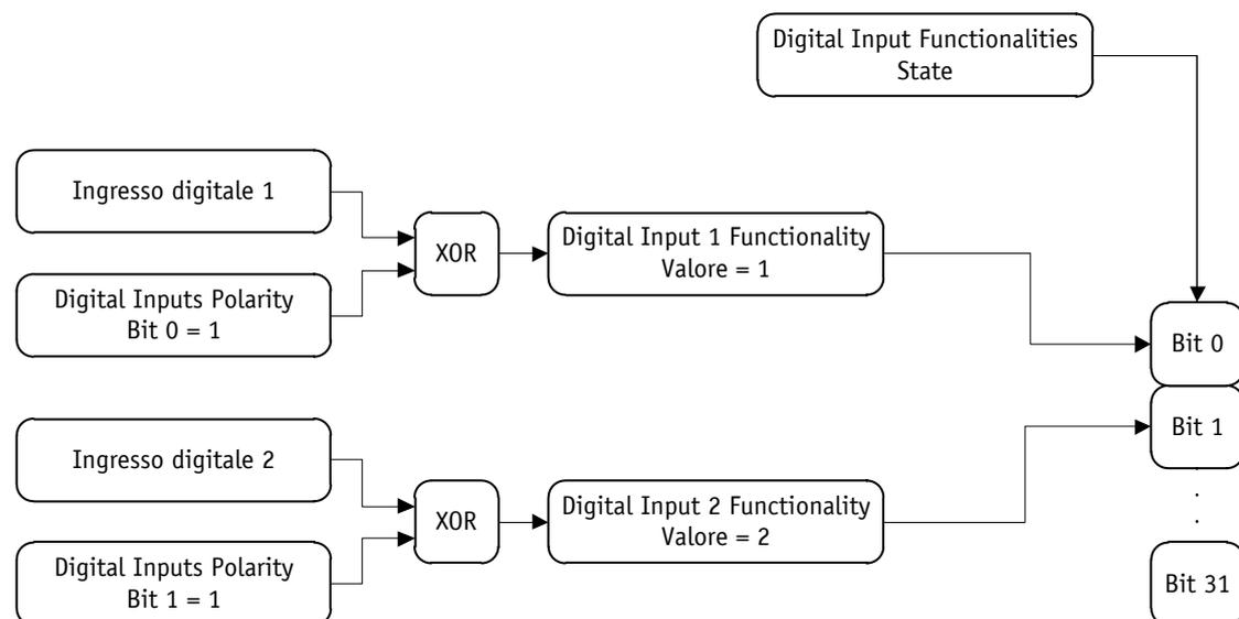
Fig. 6: configurazione esemplificativa per finecorsa
