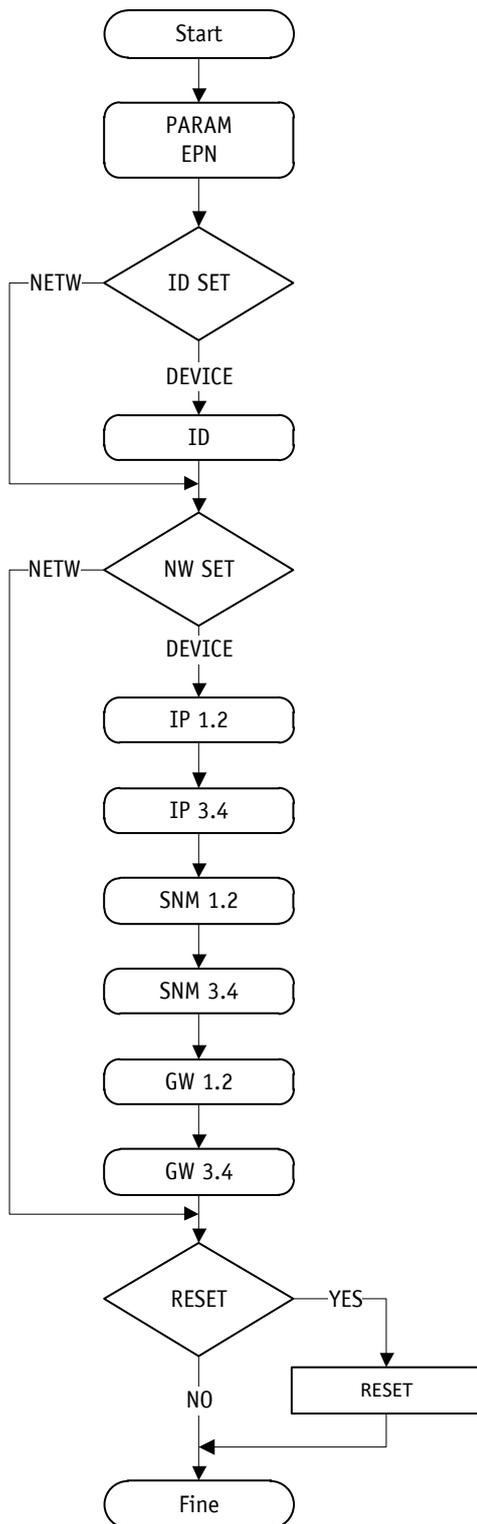
Fig. 16: Impostazione del nome della stazione e della configurazione IP
