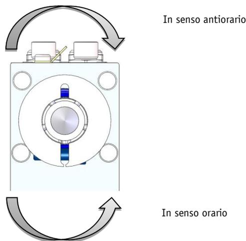
Fig. 13: senso di rotazione
