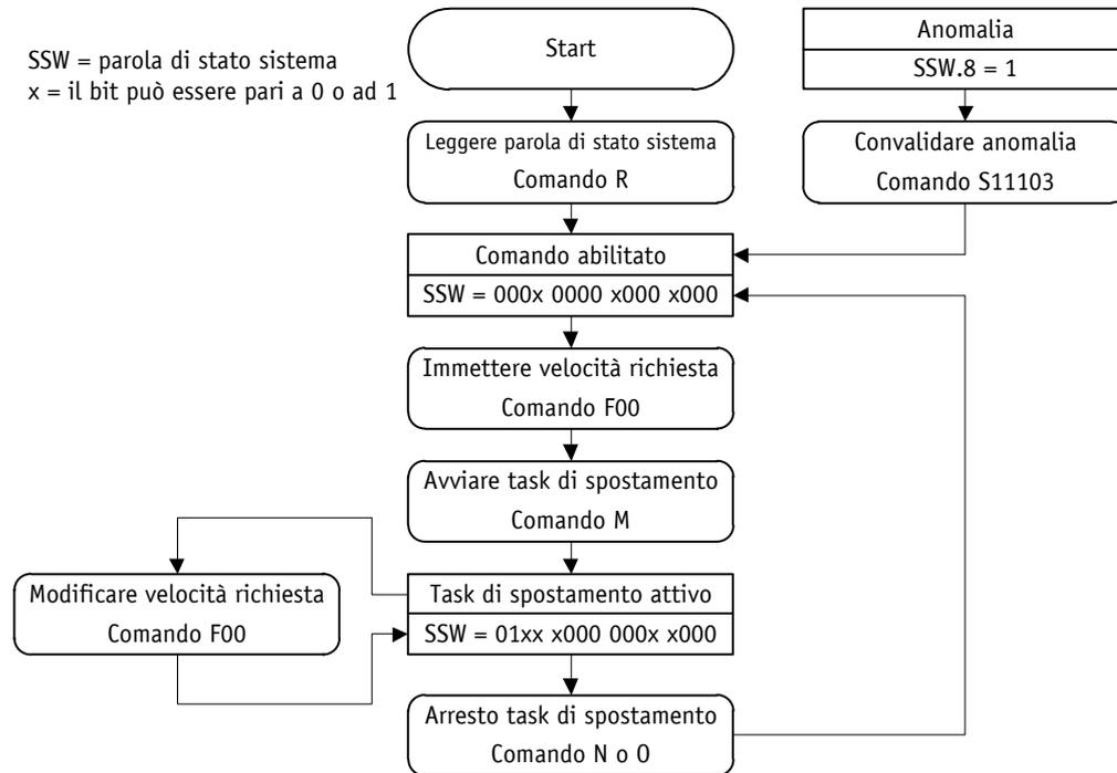
Fig. 19: diagramma di flusso modo Velocità protocollo di servizio
