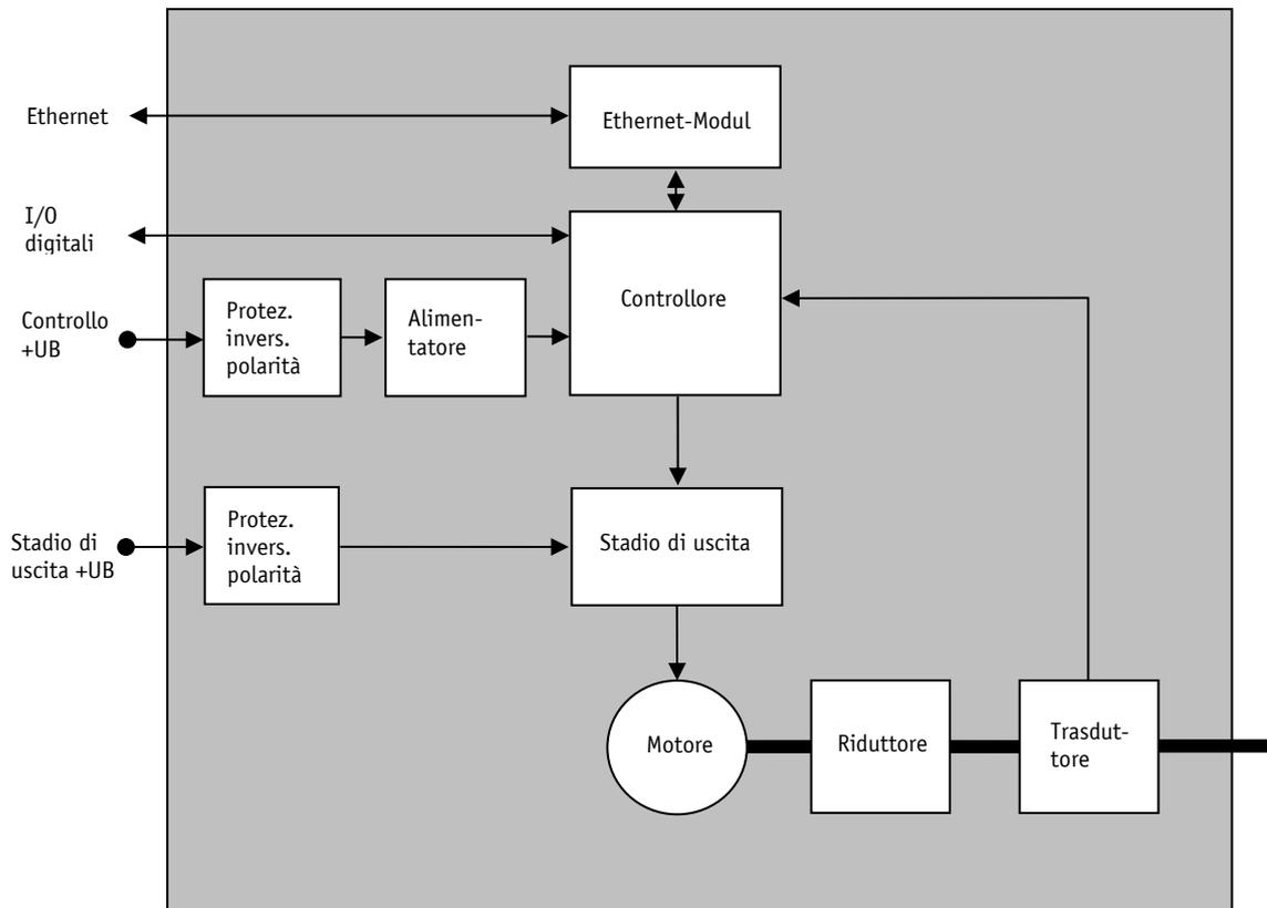
Fig. 22: diagramma a blocchi
