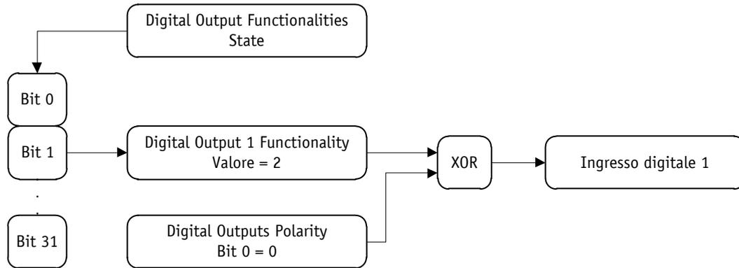
Fig. 11: configurazione esemplificativa uscita digitale
