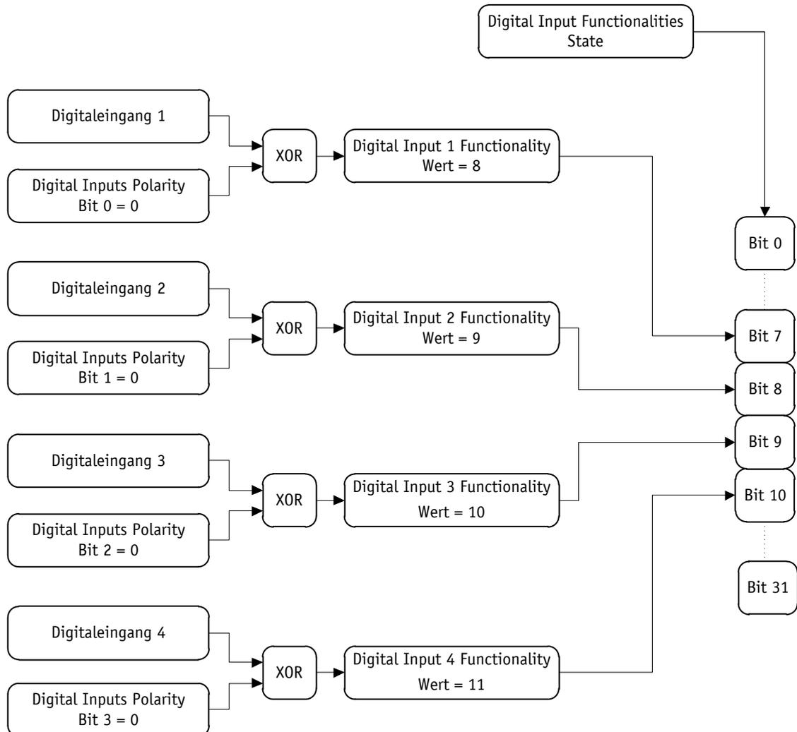
Abb. 12: Beispielkonfiguration der Digitaleingänge für den PCM
