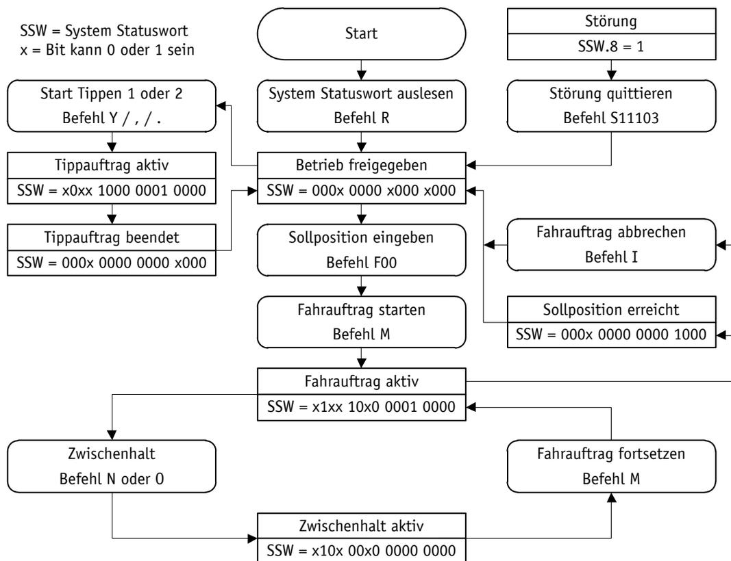
Abb. 18: Ablaufplan Positioniermodus Serviceprotokoll
