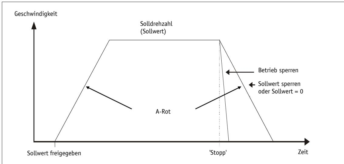
Abb. 14: Rampe Drehzahlmodus
