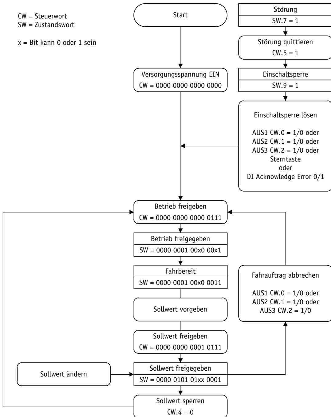
Abb. 15: Ablaufplan Drehzahlmodus
