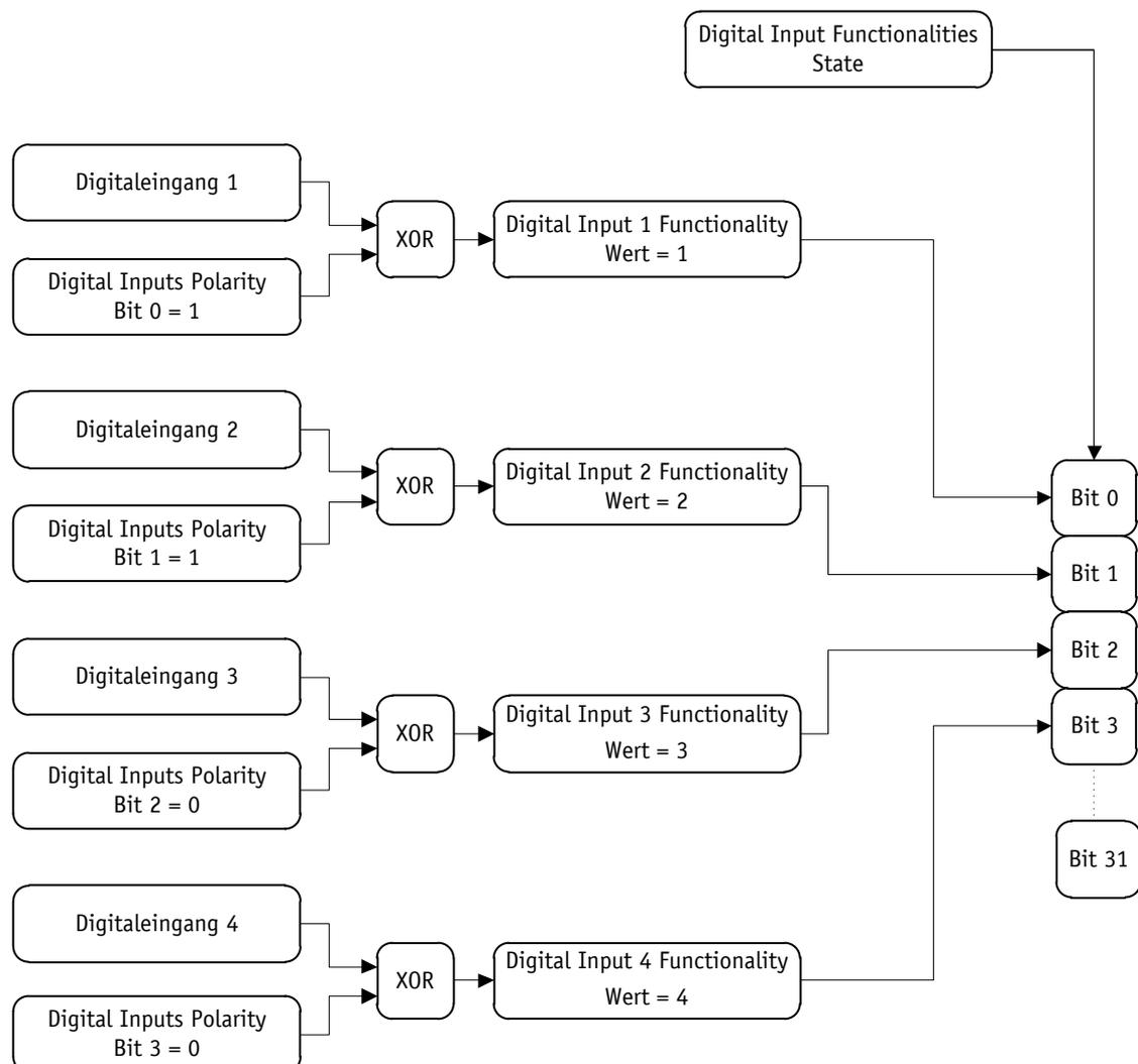
Abb. 10: Beispielkonfiguration Digitaleingänge
