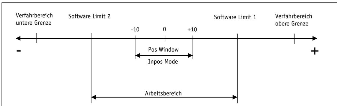
Abb. 5: Positioniermodus
