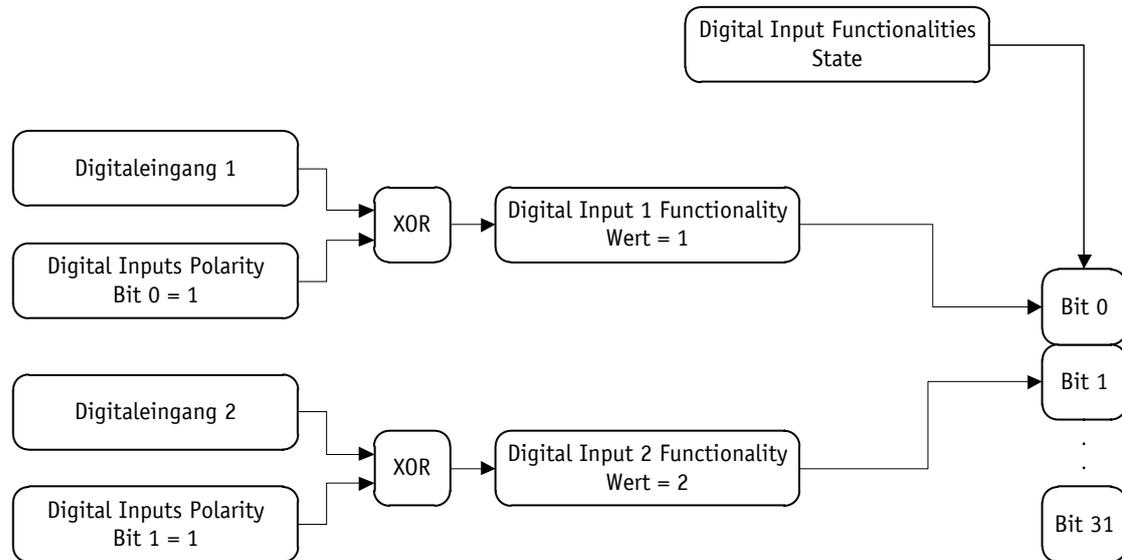
Abb. 6: Beispielkonfiguration Endschalter
