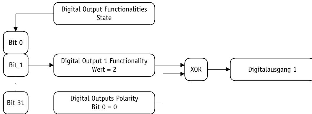
Abb. 11: Beispielkonfiguration Digitalausgang
