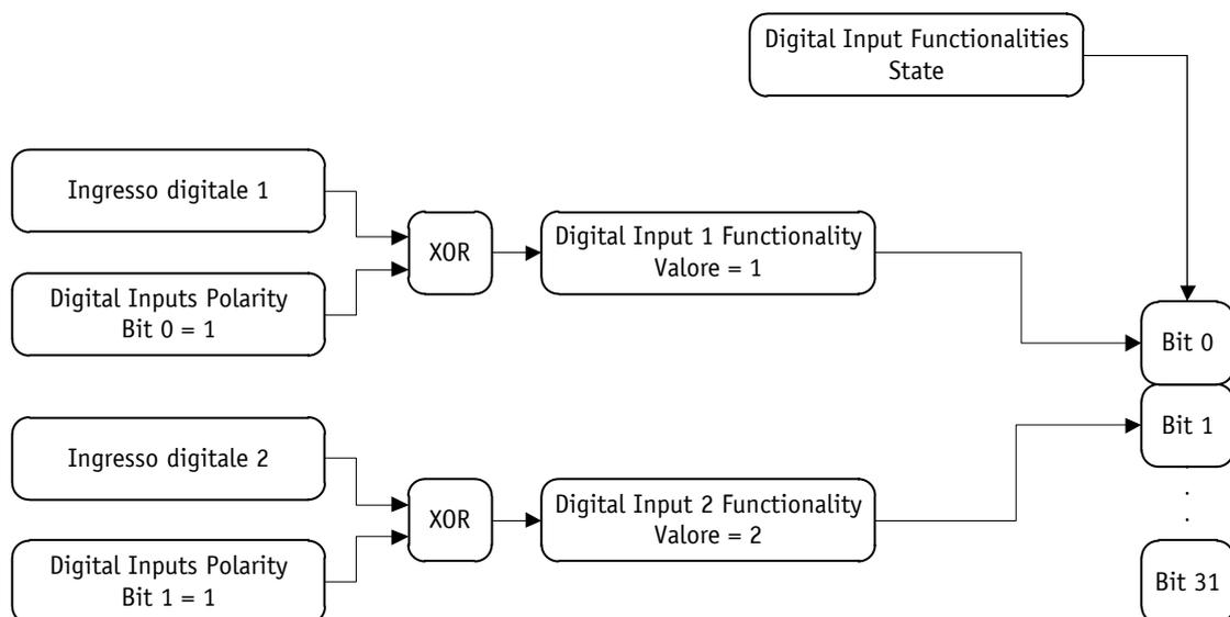
Fig. 6: configurazione esemplificativa per finecorsa
