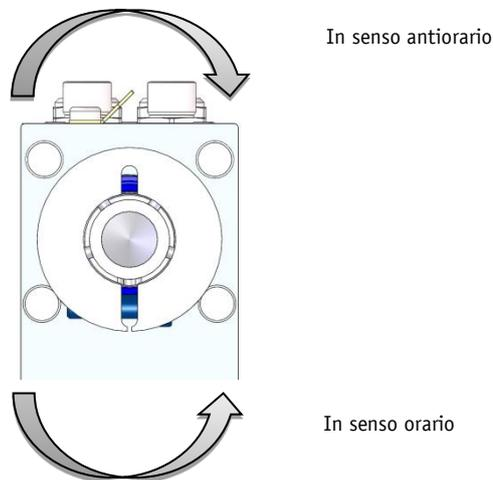
Fig. 13: senso di rotazione
