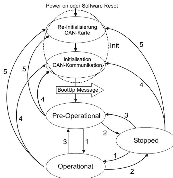
Abb. 1: CAN-Zustands-Diagramm
