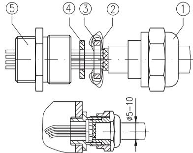
Abb. 4: Kabelanschluss PG9
