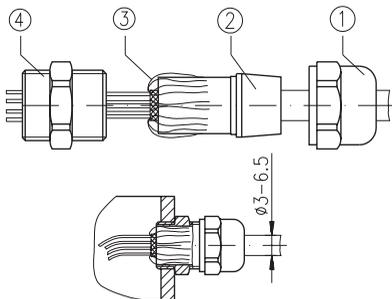
Abb. 3: Kabelanschluss PG7
