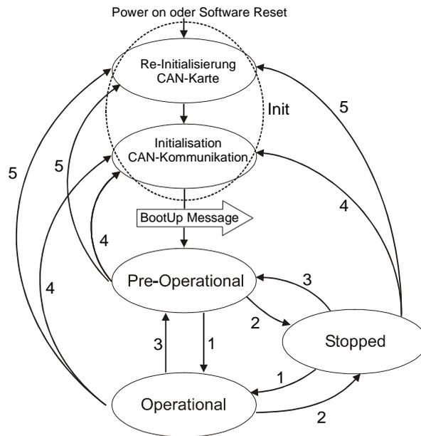
Abb. 1: CAN-Zustands-Diagramm
