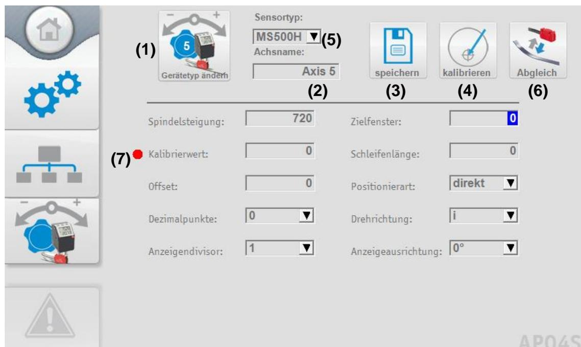
Bevor man auf die Parameterseite gelangt wird ein Abgleich der im ETC5000 und den im angeschlossenen Geräten gespeicherten Parametern durchgeführt. Bei Diskrepanzen öffnet sich ein Popup und der Anwender muss entscheiden welcher Wert gültig ist.
