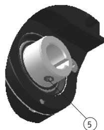
Abb. 4: Welle mit Passfedernut
