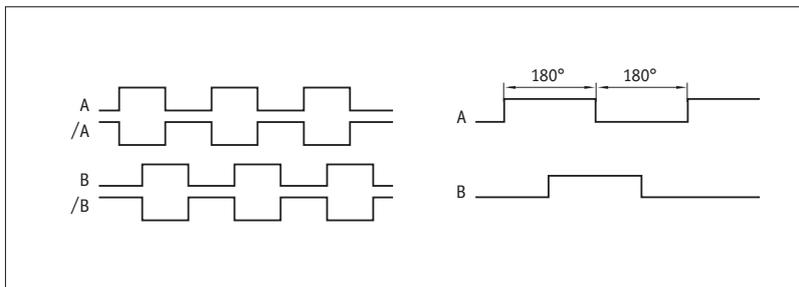
■ **Distancia entre impulsos, conexión de salida LD**
