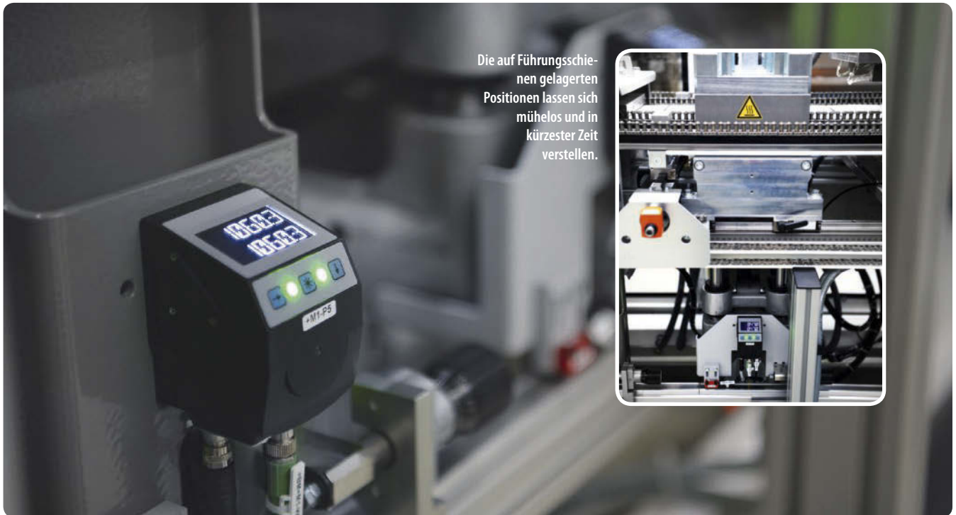
Die grünen LED-Leuchten der Positionsanzeige zeigen klar an, dass die Stationen korrekt eingestellt sind. (Bilder: Zahoransky)
