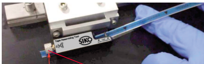
Abb. 20: Richtig positionieren mit dem Bandinstallationstool
