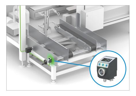
通过电子位置显示器,可精确可靠地确定设置纸箱架的中心。
