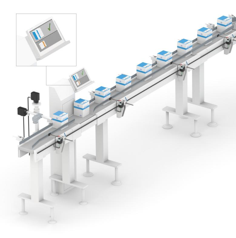
通过执行驱动器可将摄像头在水 平和垂直方向对准产品,以记录 其标识打造。
