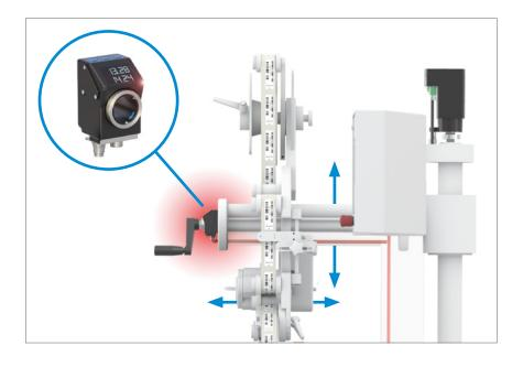
通过电子位置显示器,可高效可 靠地进行标签过程的水平定位。
