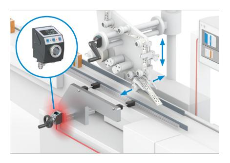
通过监控式格式调整,传送带也 将根据新包装盒格式进行调整。
