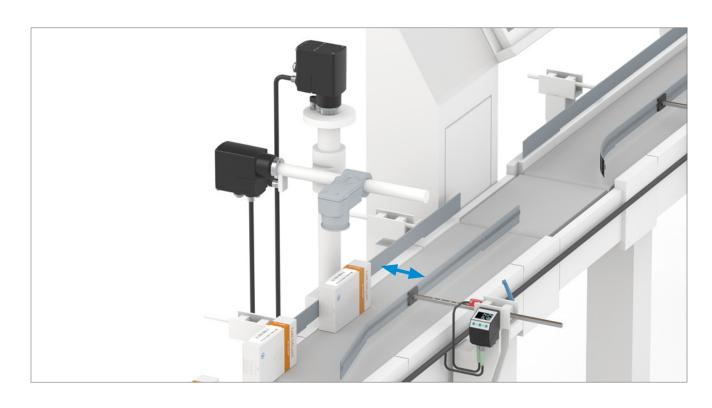
根据纸箱规格快速可靠地调整纸箱架。根据包装盒的大小及其材料的性质,必须快速可靠地调整相应的调节轴。只需按下按钮,紧凑型执行驱动器既刻移动到新的轴位置,自动实现适配下一个包装盒尺寸的调整,并具备 100% 的过程执行可靠性。
